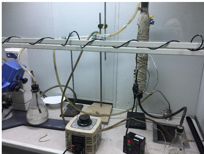
Рисунок 4.3.2 – Экспериментальная установка для пиролизного нагрева угля
