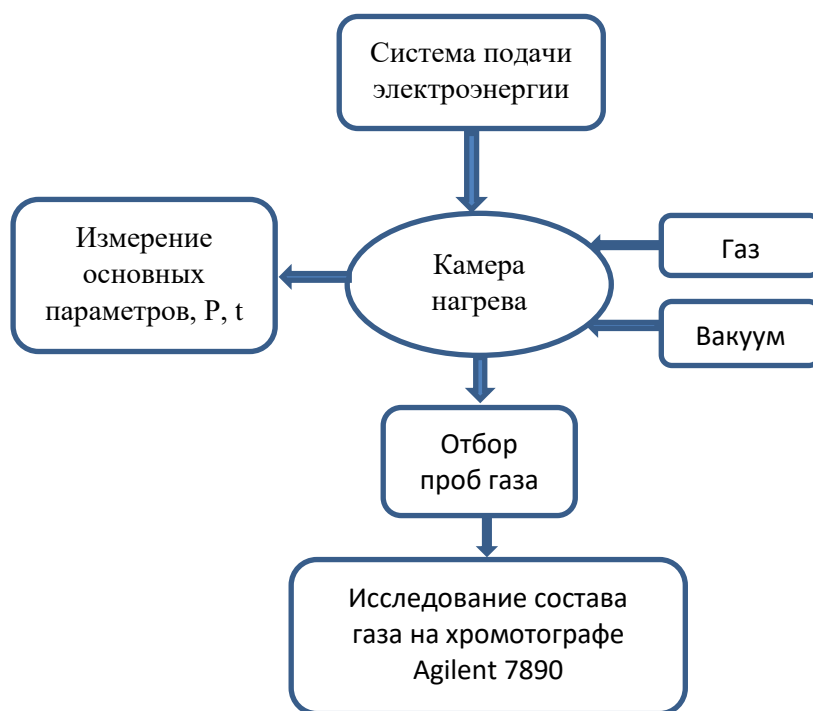
Рисунок 4.1 - Структурная схема экспериментальной установки
