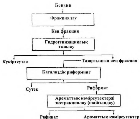
10-сурет. Ароматтық көмірсутектерді катализдік риформингімен алу сұлбасы
