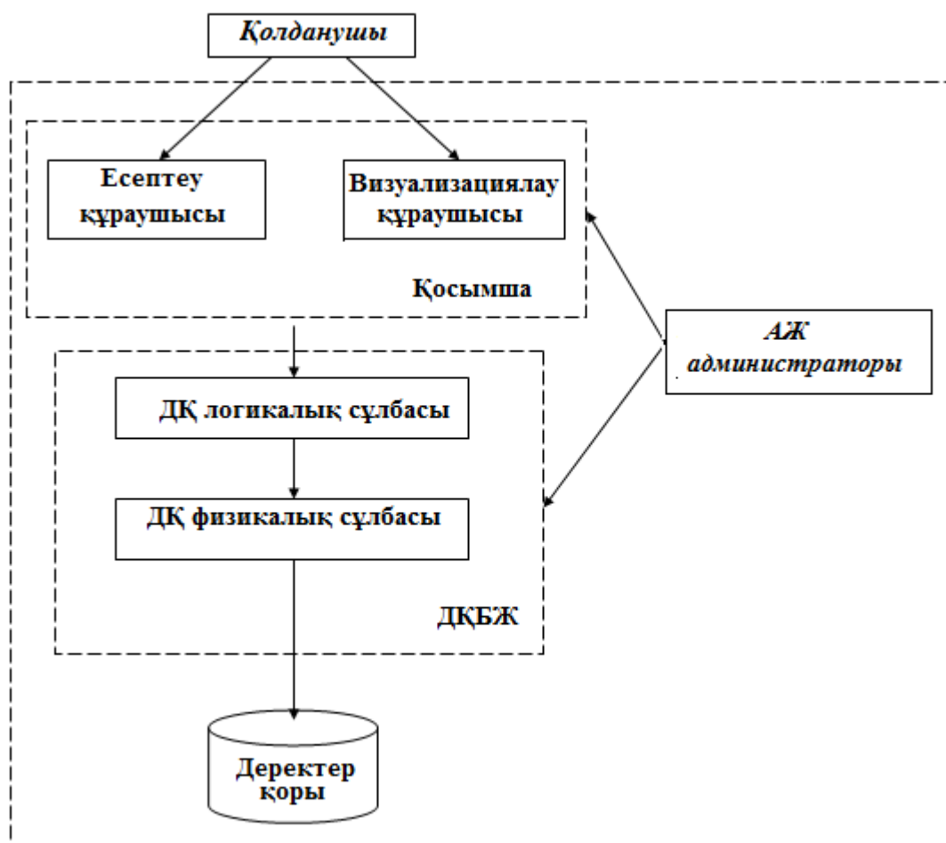
Сурет 1 – Қатты денелерде стационарлы емес толқындардың таралу есебін шешуге арналған ақпараттық жүйенің архитектурасы
