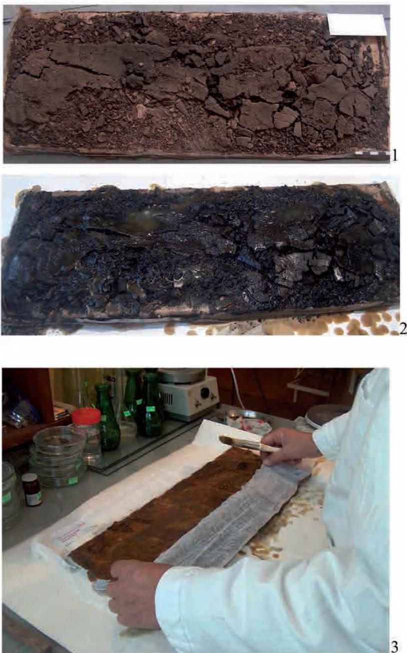
Рис. 2. Первый этап работы с объектом: 1 – внешний вид предмета после распаковки; 2 – закрепление лицевой поверхности объекта воско-канифольной смесью; 3 – укрепление лицевой поверхности двумя слоями марли и воско-канифольной смесью. Фото из архива научно-реставрационной лаборатории «Остров Крым»
