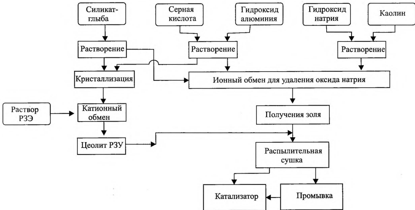
Рис. 8.3. Принципиальная схема получения цеолитсодержащих катализаторов крекинга по золевой технологии
