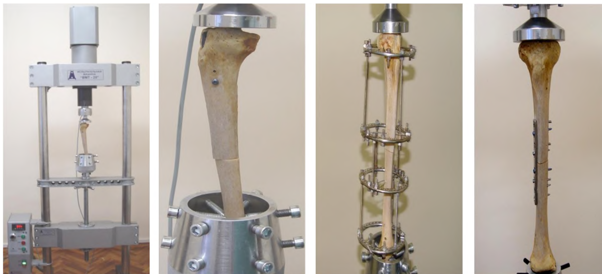
Рисунок 3 – Испытание модели на «сжатие».
