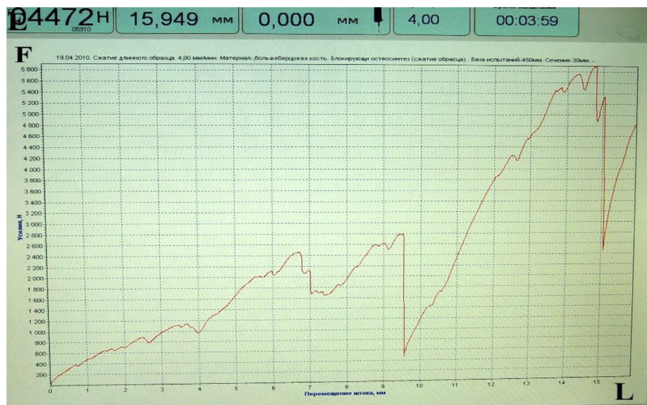
Рисунок 4 – Показания усиления нагрузки, скорость перемещения штока, время испытания, диаграмма деформирования модели перелома.
